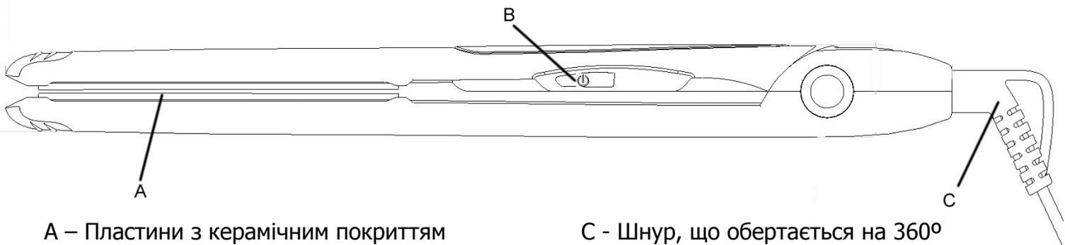
A – Пластини з керамічним покриттям
