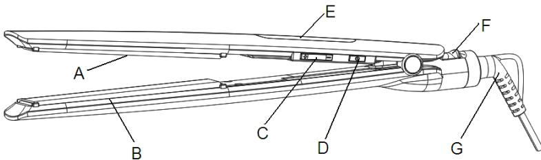
A – Пластина с керамическим покрытием
