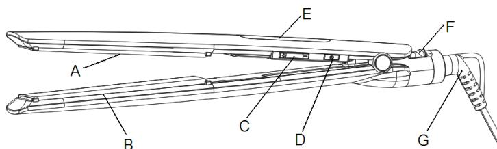
A, B – Пластини з керамічним покриттям
